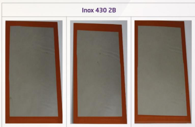
Figura 1 - Aspecto dos corpos de prova dos aços 430 2B, ensaiados após 30 dias de exposição em câmara de névoa salina.
