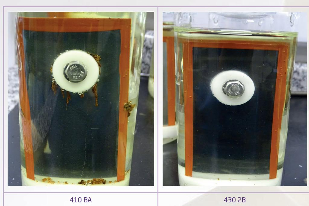
Após os 13 dias de ensaios podemos ver como o meio é agressivo a ambas as ligas, porém o 430 demonstra maior resistência e um aspecto menos corroído. Note que além da corrosão esperada nas frestas geradas artificialmente para acelerar o ensaio, a corrosão em toda a face do corpo de prova é acentuada no 410.
