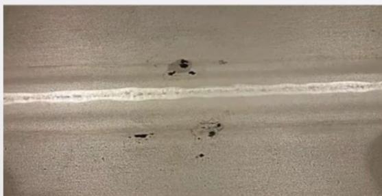
Figura 1 - Exemplo de corrosão por pites em aços inoxidáveis.
