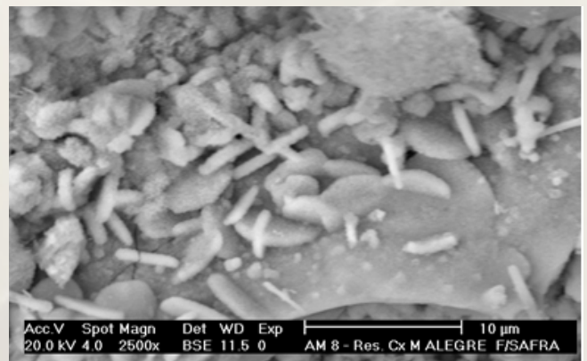
Fig 2 - MEV Bactérias sulfato redutoras presentes na região da Fig1.
