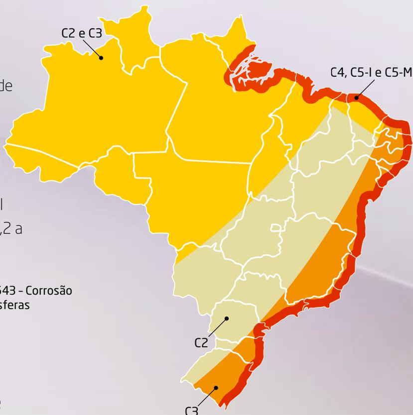
Figura 1: Mapa ilustrativo conforme a ABNT NBR 14643 - Corrosão atmosférica - Classificação da corrosividade de atmosferas
