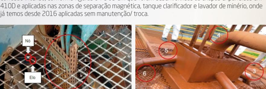
Figura 04 e 05 - Inox 410D aplicado nas zonas de separação magnética, tanque clarificador e lavador de minério (Mineradora).
