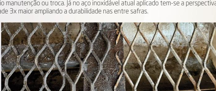
Figura 06 - Aço Carbono x Aço inox nas chapas expandidas das zonas de piso operacional da moenda (Usina de Açúcar).
