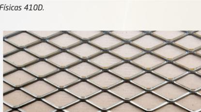
Figura 03 - Chapa expandida de Aço Inox 410.
