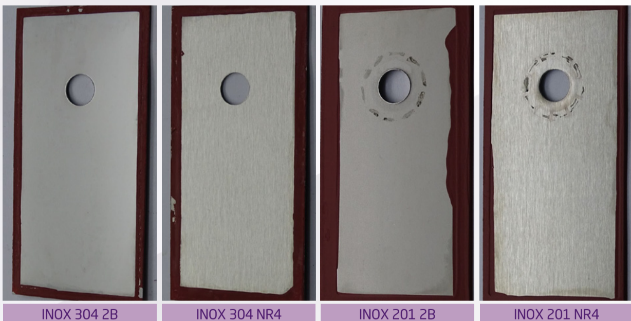
Figura 2 - Comparativo de Resistência à corrosão das amostras de inox 304 x "inox 201".
