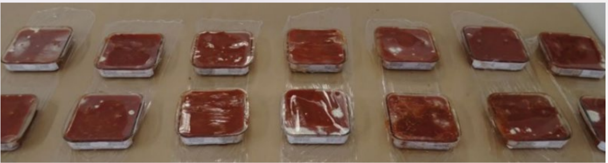
Figura 1 - Disposição das amostras na imersão/ contato em molho de tomate
