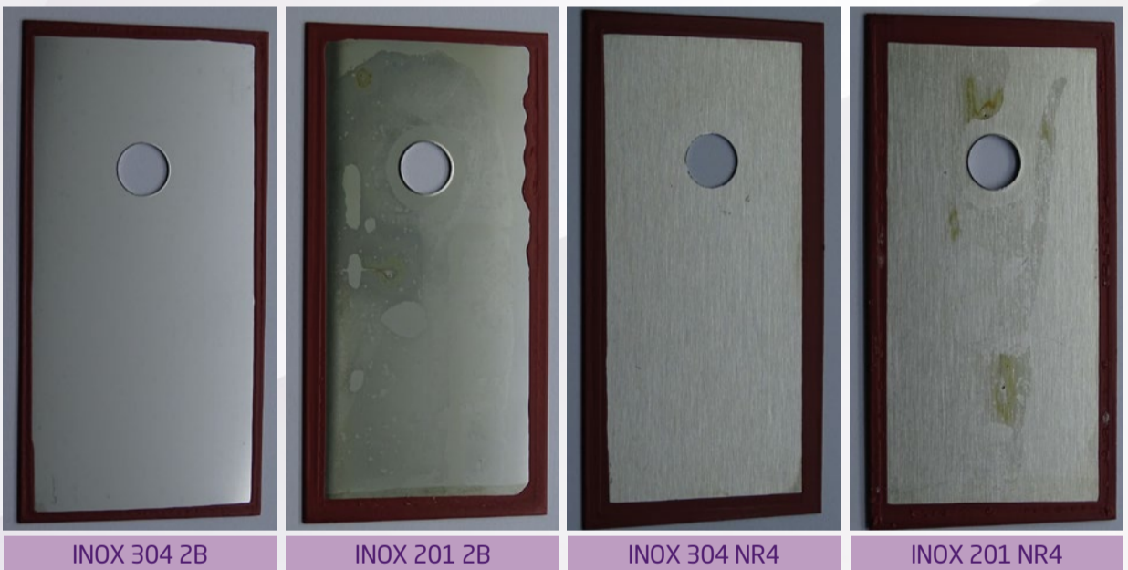
Figura 2 - Comparativo de Resistência à corrosão das amostras de 304 x "201" nos acabamentos brilhantes e lixados.
