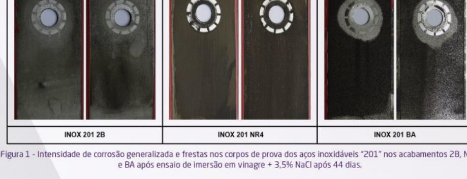
Figura 1 - Intensidade de corrosão generalizada e frestas nos corpos de prova dos aços inoxidáveis "201" nos acabamentos 2B, NR4 e BA após ensaio de imersão em vinagre + 3,5% NaCl após 44 dias.
