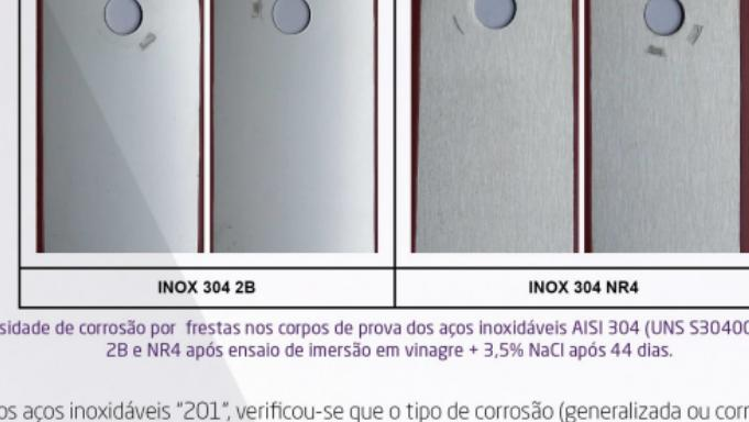
Figura 2 - Intensidade de corrosão por frestas nos corpos de prova dos aços inoxidáveis AISI 304 (UNS S30400) nos acabamentos 2B e NR4 após ensaio de imersão em vinagre + 3,5% NaCl após 44 dias.
