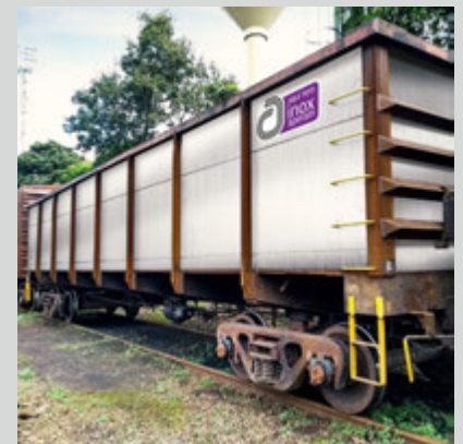
Aplicação do ENDUR® em vagões de carga
