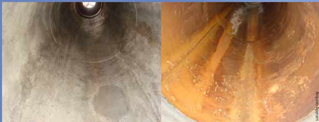
Após uma safra em operação, a coluna de sulfitação em inox 317L (à esquerda) apresentou menor desgaste que aquela feita em aço carbono (à direita)
