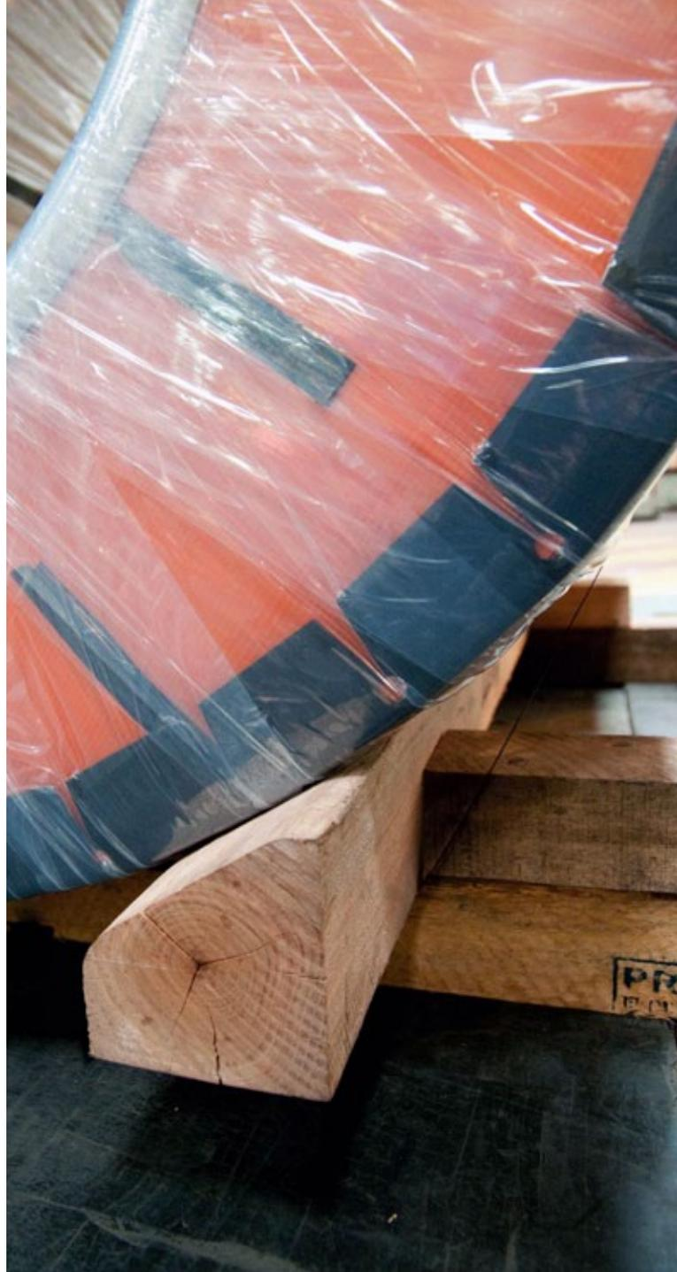
Novo modelo de estrados evita deformações e imperfeições nas bobinas, que chegam em perfeito estado aos clientes
