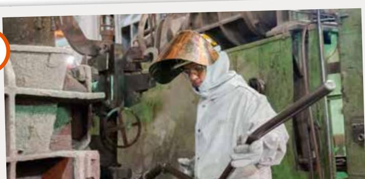
Com a conclusão do sequencial, fazemos o *setup* na máquina, que consiste em atividades de operação e pequenas intervenções para que ela volte a operar. O *setup* dura cerca de 75 minutos e inclui atividades como a troca de distribuidores e o ajuste da largura (bitola) do molde utilizado para lingotar. Só então, a máquina está pronta para iniciar as próximas corridas.
