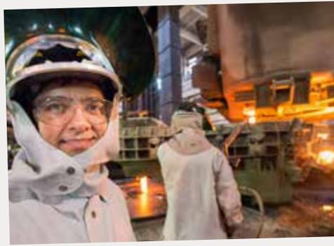
O processamento do metal líquido na máquina, resultando na formação de uma placa, é chamado de lingotamento. O tempo de lingotamento de uma corrida com 90 toneladas de aço na placa dura, em média, 60 minutos. O sequencial, por sua vez, nada mais é que a realização de várias corridas ininterruptas, sem a necessidade de parada do equipamento para *setup*.
