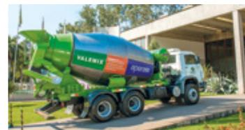
Testes piloto nas facas de caminhões betoneira apontaram para uma superioridade acima de 200% para o aço inox devido à maior resistência ao efeito combinado de abrasão e corrosão. O mesmo desempenho é visto na estrutura do balão da betoneira.
