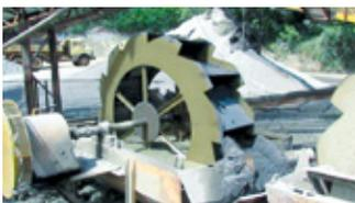
Equipamento industrial utilizado para testes de desgaste em meio úmido. Com a maior parte construída em aço inox, sendo 9 pás em inoxidável e 3 em aço carbono, o teste foi realizado com pó de pedra granulada e água. Após um ano, o comparativo de longevidade confirmou a resistência ao desgaste e melhor desempenho do aço inox.
