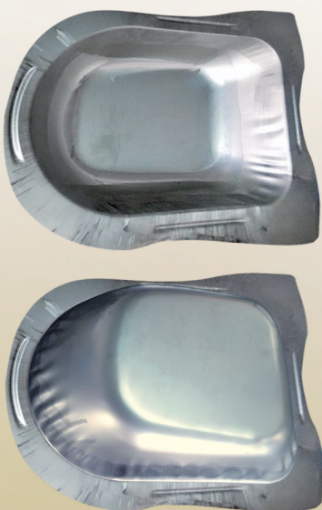
Estampagem da caçamba com profundidade rasa e profunda em 409:
