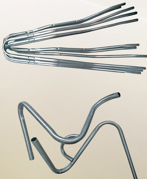
Conformação dos tubos para estrutura (Varal e Travessão) em 409:
