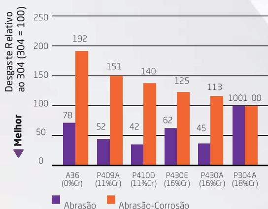
Havendo agente corrosivo, a resistência à corrosão afeta a resistência ao desgaste. Maior teor de Cr, maior resistência à corrosão, o que aumenta a resistência ao desgaste no meio corrosivo.
