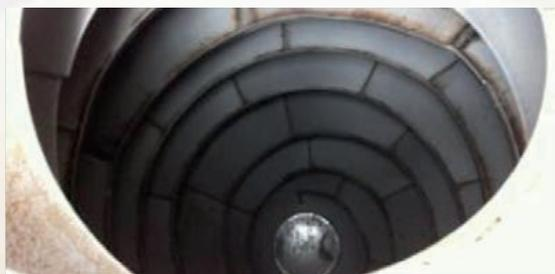
Como teste piloto, facas internas de um caminhão betoneira foram produzidas em aço P410M (segunda geração do aço P410D).
