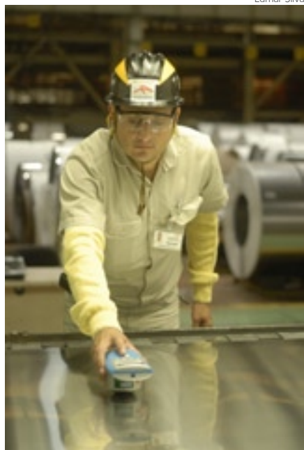
Geovane mede a tonalidade do aço com o espectrofotômetro
